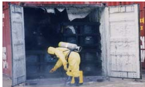
(그림8) 염화수소가스의 발연(發煙)에 의해 부식된 드럼 및 컨테이너
