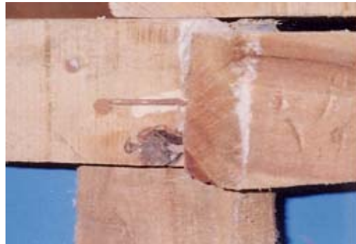
(그림7) 목재살상자에 4-5cm 돌출(突出)된 못(Nail)
