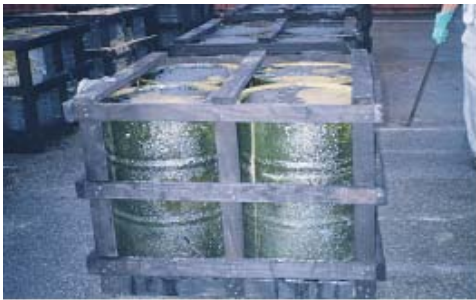
(그림8) 염화수소가스의 발연(發煙)에 의해 부식된 드럼 및 컨테이너
