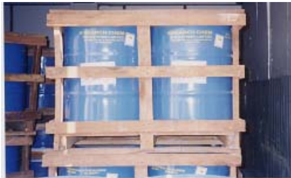
(그림2) 4드럼을 한 개의 목재살상자를 이용한 단위화물 (Unit Load)
